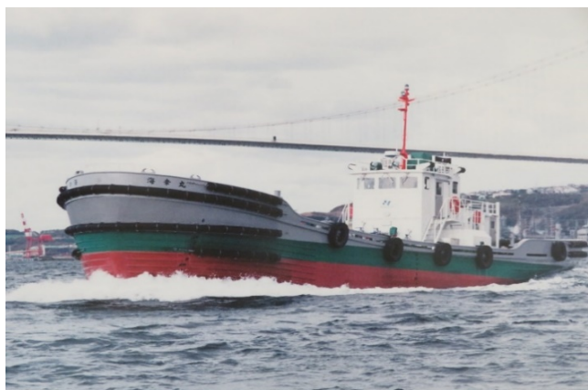
ナラサキ石油が所有するバイオ燃料燃焼実験船（海幸丸）
